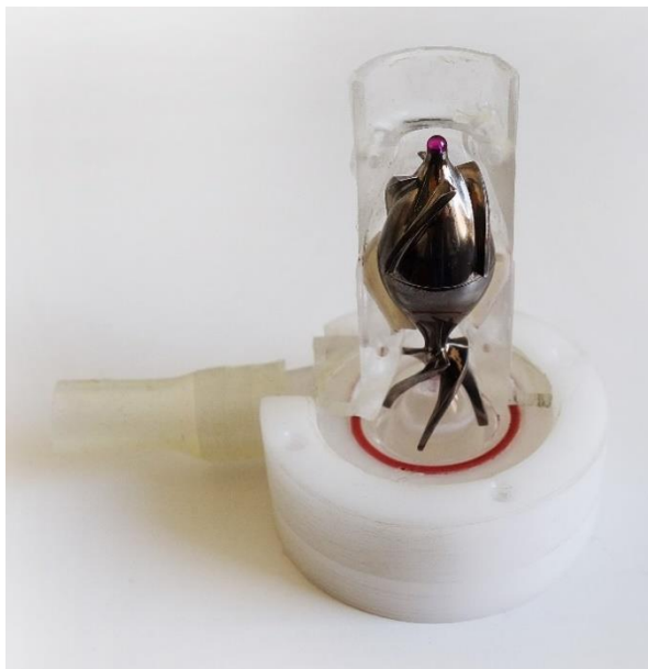
Bild 8-25: Zweistufige halbaxiale Herzunterstützungspumpe Careflow
